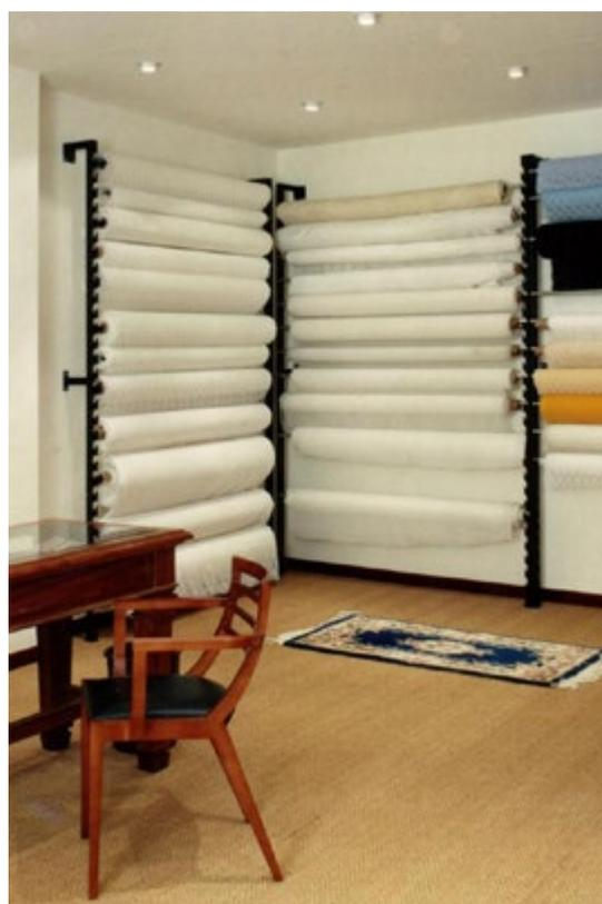
Toda la **serie Cremallera** está construida con un mismo perfil con encajes cada 7,5 cms. para barras de 25 mm. Ø que sostienen la pieza por su interior y se apoyan en la cremallera por sus extremos. La separación entre encajes facilita la combinación de distintos diámetros de pieza aprovechando al máximo todo el espacio disponible. Las instalaciones contiguas con estos expositores, son funcionales y además, decorativas.
